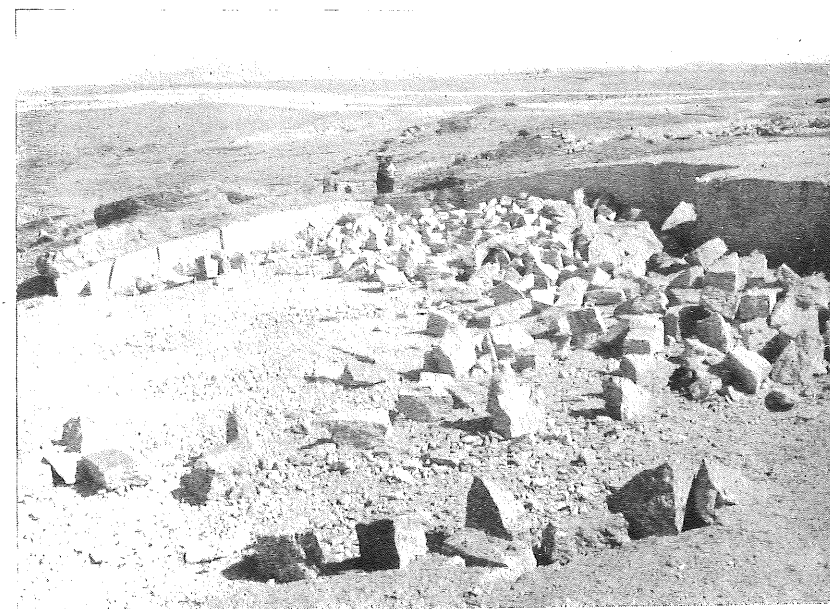
Fig. 1.—Cantera abierta en la masa de granitos de grano gordo en las inmediaciones de Campanario. Esta roca se emplea en mampostería basta. IX-53.
